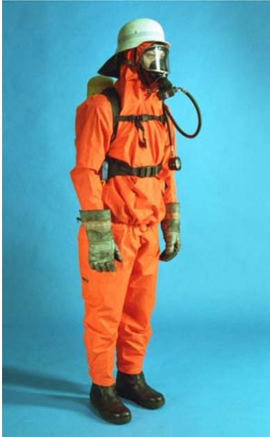
Flüssigkeitsschutzanzug speziell für den C-Einsatz
